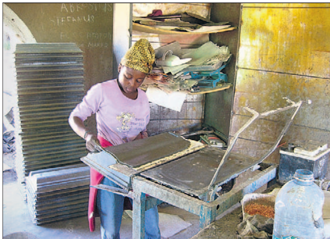
Fertigung der Dachziegel in der projekteigenen Werkstatt
